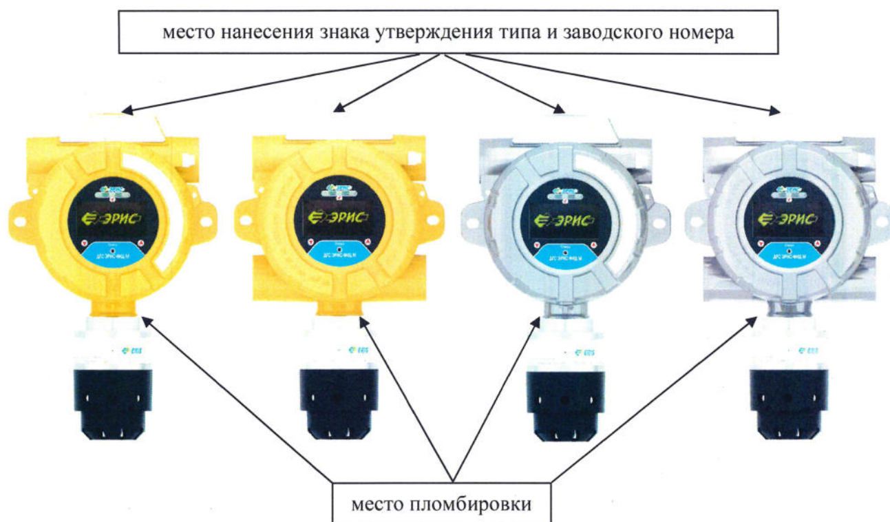
Рисунок 2 – Общий вид газоанализатора стационарного ДГС ЭРИС-ФИД М корпус типа Б с указанием мест нанесения знака утверждения типа и заводского номера, мест пломбировки от несанкционированного доступа. Слева-направо: алюминиевый и стальной корпус с 2 или 4 отверстиями для подключения внешних цепей
